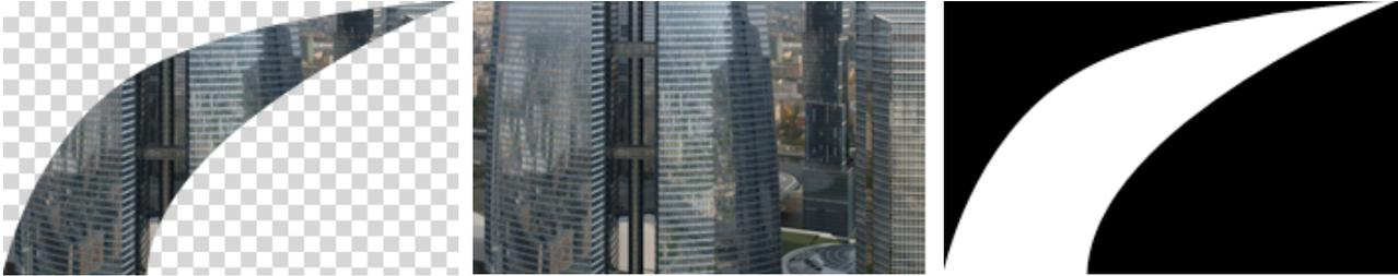
Une image PNG de type 6 (comme celle représentée ci-dessus à gauche) est en pratique composée d'une image 24 bits « Truecolour » (8 bits par composant RVB : Rouge, Vert et Bleu - représentée au centre) ainsi qu'un canal de transparence (8 bits Alpha - représenté à droite).
